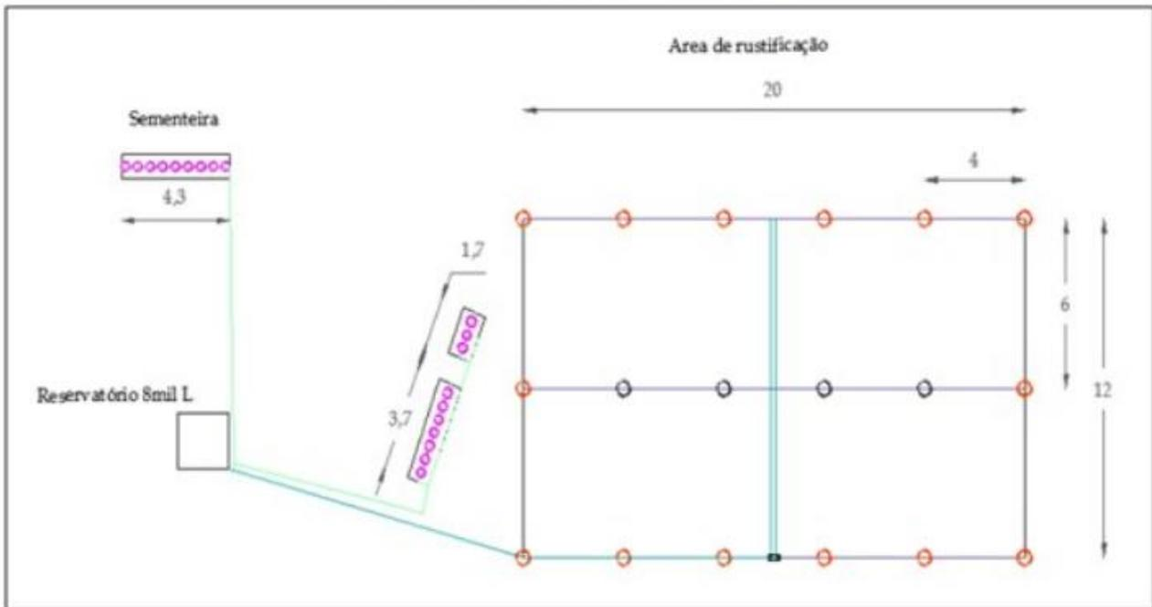
**Figura 02. Representação do sistema hidráulico na área de rustificação**
